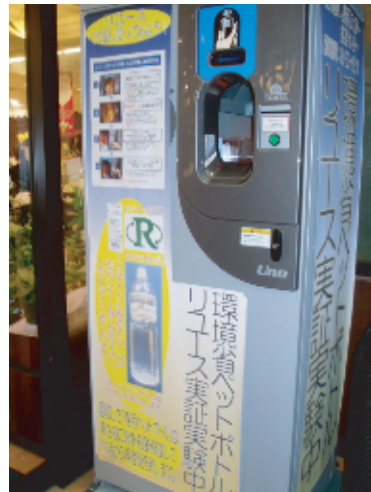
店頭に設置されたスウェーデン製のリユースペットボトル回収機
