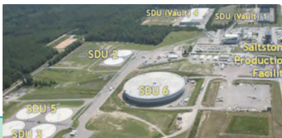
写真：米国サバンナリバー核施設にて実施中の低レベル廃液モルタル固化施設
